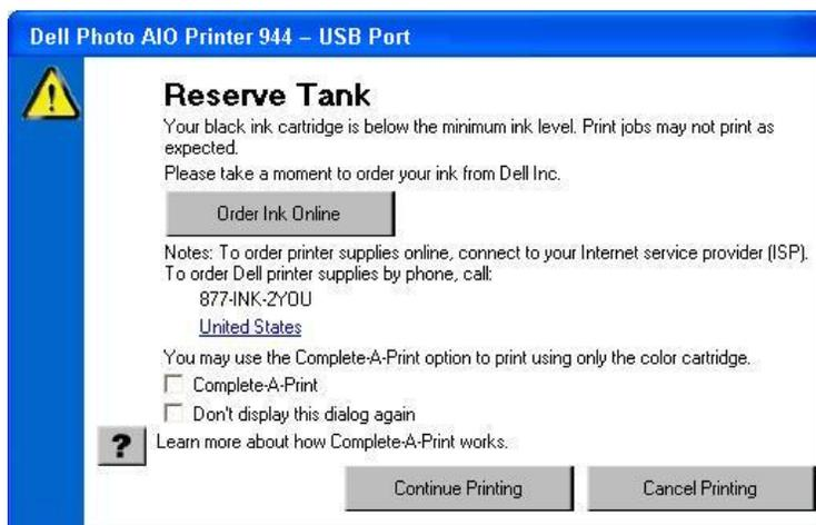
カラーカートリッジがインク切れの場合、「**印刷を完了**」を選択してから「**印刷続行**」ボタンをクリックして、カラーのドキュメントをグレースケールで印刷することができます。「**印刷を完了**」を選択して「**印刷続行**」をクリックすると、カラーカートリッジを交換するか、「**印刷設定**」の「**アドバンス**」タブにある「**その他のオプション**」からオプションの選択を解除するまで、すべてのカラードキュメントはモノクロで印刷されます。インク切れのカートリッジが交換されるまで、「**予備タンク**」ダイアログは表示されません。新しいカートリッジまたは別のカートリッジが取り付けられると、「**印刷を完了**」チェックボックスは自動的にオフになります。
